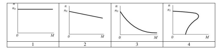
17. Искусственная механическая характеристика синхронного двигателя, изображенная на рисунке, соответствует ....
