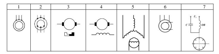
14. Какой из рисунков иллюстрирует устройство и принцип действия синхронного двигателя?
